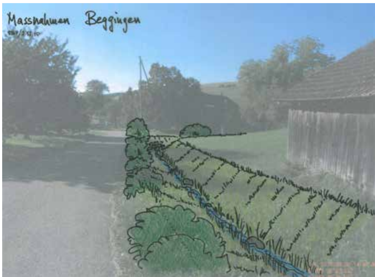
Abbildung 39: Visualisierung des ausgedolten und renaturierten Schwebelbaches
