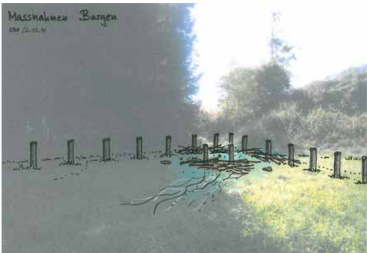
Abbildung 35: Visualisierung des Schwemmholzrechens
