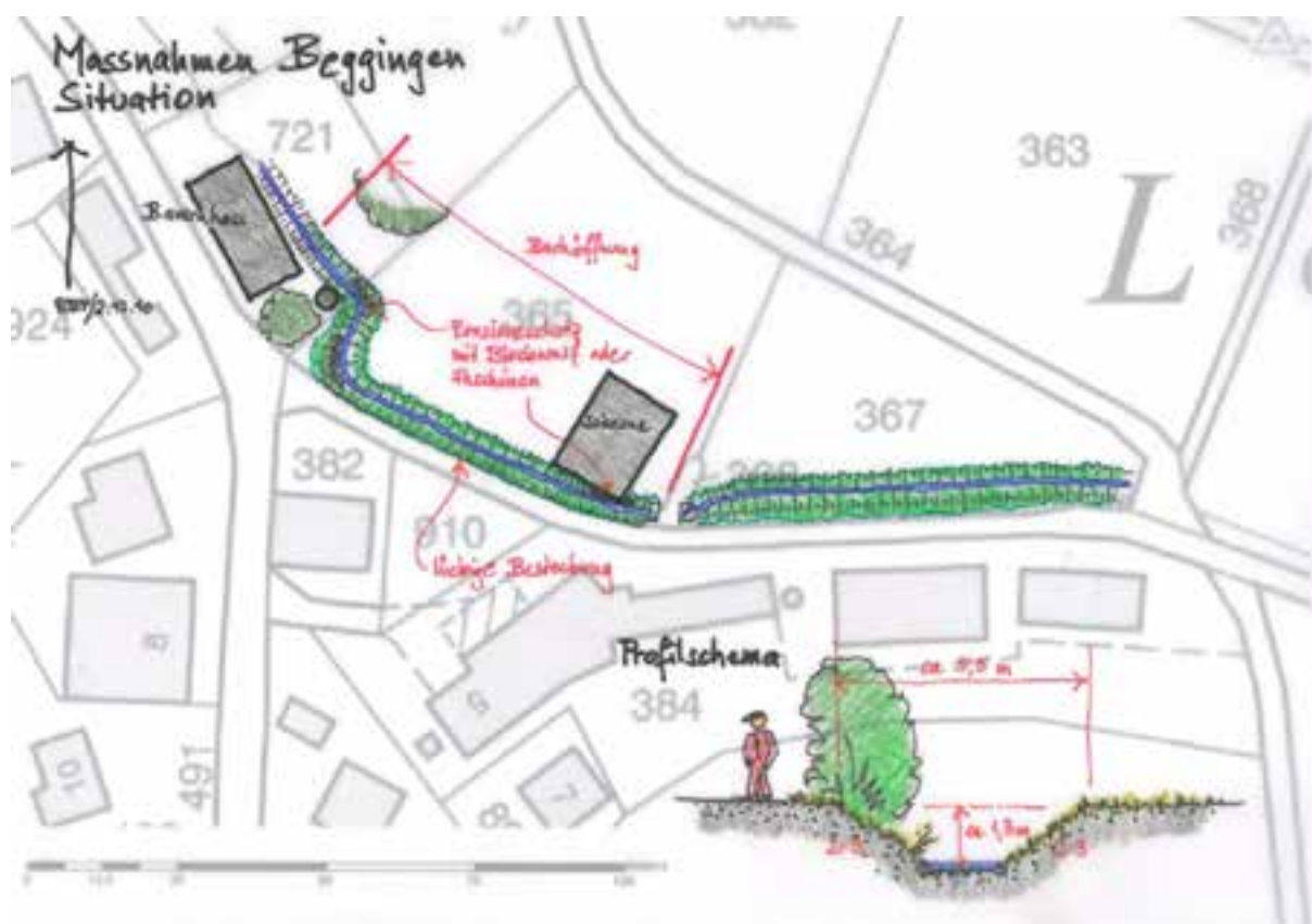
Abbildung 38: Linienführung des ausgedolten Abschnittes des Schwebelbaches
