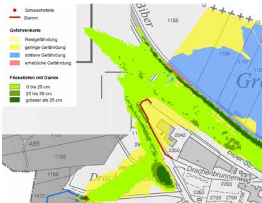
Abbildung 28 Durch den Drachengraben überflutete Fläche bei Realisierung eines Leitdamms entlang der Reiatstrasse (grün, HQ300), im Vergleich mit der Gefahrenkarte.
